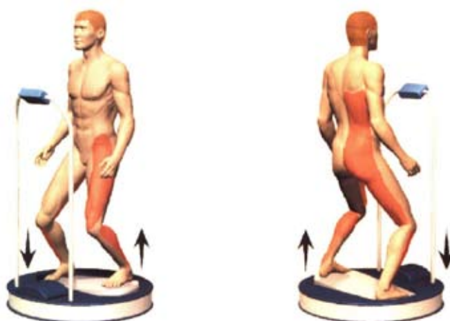
Рис. 1. Схематическое представление характера колебаний вибрационной платформы относительно стоящего на ней человека.
